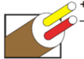
ULPower thermocouple extension type : ANSI
